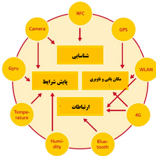
شکل (۴) فناوری حسگرهای موجود در ابزارهای همراه و کاربرد آنها در لجستیک
