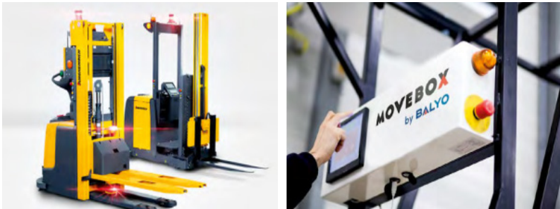
شکل (۳) روش جدید حرکت دادن پالت‌ها (چپ)، روش ابتکاری چرخش لیفت تراک به سمت ماشین خودران (راست)
